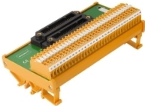
**Analogschnittstellen sind mit 40-poligen Steckverbindern (KS) versehen. Die Versionen mit Trennsteckern und Prüfabgriffen sind bestens für Spannungs- und Strommessungen geeignet. Die Versionen mit nützlichen Zusatzstiften sind für den Kunden interessant, der mit weiteren Elementen (z. B. Widerstände) Strom/Spannung umwandeln oder Stromschleifen überwachen will.**
