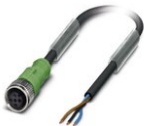
Sensor-/Aktor-Kabel, 3-polig, PVC, schwarz RAL 9005, freies Leitungsende, auf Buchse gerade M12, Kodierung: A, Kabellänge: 5 m
