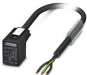
Sensor-/Aktor-Kabel, 3-polig, PVC, schwarz RAL 9005, freies Leitungsende, auf Ventilstecker BI (11 mm), mit 1 LED, beschaltet mit Z-Diode, Kabellänge: 10 m
