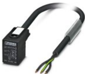
Sensor-/Aktor-Kabel, 3-polig, PVC, schwarz RAL 9005, freies Leitungsende, auf Ventilstecker B (10 mm), mit 1 LED, beschaltet mit Z-Diode, Kabellänge: 10 m
