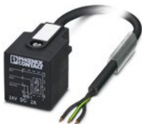
Sensor-/Aktor-Kabel, 3-polig, PUR halogenfrei, schwarzgrau RAL 7021, freies Leitungsende, auf Ventilstecker A, mit 1 LED, beschaltet mit Freilaufdiode, Kabellänge: 5 m
