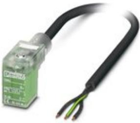
Sensor-/Aktor-Kabel, 3-polig, PUR halogenfrei, schwarzgrau RAL 7021, freies Leitungsende, auf Ventilstecker C (8 mm), mit 1 LED, beschaltet mit Freilaufdiode, Kabellänge: 3 m, mit Haltestrombegrenzer zur Energiereduzierung
