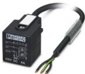
Sensor-/Aktor-Kabel, 3-polig, PUR halogenfrei, schwarzgrau RAL 7021, freies Leitungsende, auf Ventilstecker A, mit 1 LED, beschaltet mit Varistor, Kabellänge: 10 m
