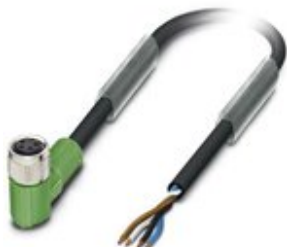
Kabel czujnika/urządzenia wykonawczego, 4-bieg., PCW, czarny RAL 9005, wolny koniec przewodu, na Gniazdo kątowe M8, długość kabla: 5 m
