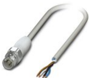
Sensor-/Aktor-Kabel, 4-polig, PP-EPDM, grau RAL 7035, Stecker gerade M12, Kodierung: A, auf freies Leitungsende, Kabellänge: 3 m, Hygienic Design, mit Edelstahlrändel
