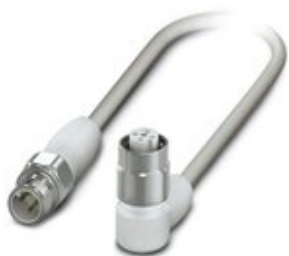
Sensor-/Aktor-Kabel, 4-polig, PP-EPDM, grau RAL 7035, Stecker gerade M12, Kodierung: A, auf Buchse gewinkelt M12, Kodierung: A, mit 3 LEDs, Kabellänge: 0,6 m, Hygienic Design, mit Edelstahlrändel
