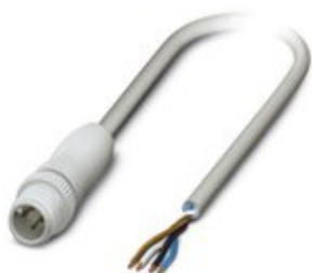
Sensor-/Aktor-Kabel, 4-polig, PP-EPDM, grau RAL 7035, Stecker gerade M12, Kodierung: A, auf freies Leitungsende, Kabellänge: 3 m, Hygienic Design, mit Kunststofffrädel
