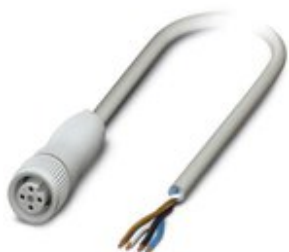
Sensor-/Aktor-Kabel, 4-polig, PP-EPDM, grau RAL 7035, freies Leitungsende, auf Buchse gerade M12, Kodierung: A, Kabellänge: 1,5 m, Hygienic Design, mit Kunststofffrädel
