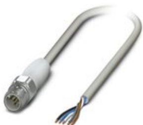
Sensor-/Aktor-Kabel, 5-polig, PP-EPDM halogenfrei, grau RAL 7035, Stecker gerade M12, Kodierung: A, auf freies Leitungsende, Kabellänge: 3 m, Hygienic Design, mit Edelstahlrändel
