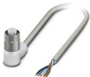
Sensor-/Aktor-Kabel, 5-polig, PP-EPDM halogenfrei, grau RAL 7035, freies Leitungsende, auf Buchse gewinkelt M12, Kodierung: A, Kabellänge: 10 m, Hygienic Design, mit Edelstahlrändel
