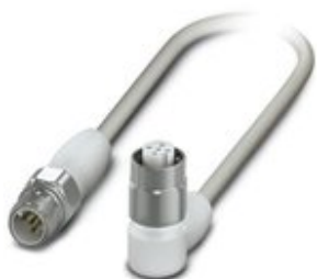
Sensor-/Aktor-Kabel, 5-polig, PP-EPDM halogenfrei, grau RAL 7035, Stecker gerade M12, Kodierung: A, auf Buchse gewinkelt M12, Kodierung: A, Kabellänge: 1,5 m, Hygienic Design, mit Edelstahlrändel
