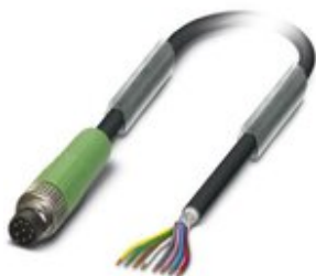
Sensor-/Aktor-Kabel, 8-polig, PUR halogenfrei, schwarzgrau RAL 7021, geschirmt, Stecker gerade M8, auf freies Leitungsende, Kabellänge: 5 m
