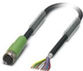
Sensor-/Aktor-Kabel, 8-polig, PUR halogenfrei, schwarzgrau RAL 7021, geschirmt, freies Leitungsende, auf Buchse gerade M8, Kabellänge: 3 m
