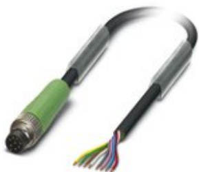
Sensor-/Aktor-Kabel, 8-polig, PUR halogenfrei, schwarzgrau RAL 7021, Stecker gerade M8, auf freies Leitungsende, Kabellänge: 1,5 m
