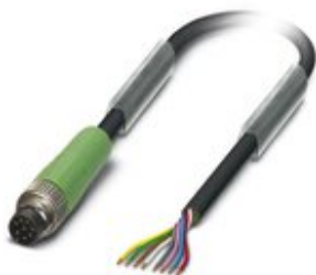
Sensor-/Aktor-Kabel, 8-polig, PUR halogenfrei, schwarzgrau RAL 7021, Stecker gerade M8, auf freies Leitungsende, Kabellänge: 10 m
