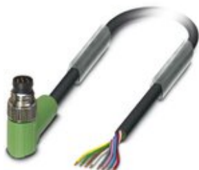
Sensor-/Aktor-Kabel, 8-polig, PUR halogenfrei, schwarzgrau RAL 7021, Stecker gewinkelt M8, auf freies Leitungsende, Kabellänge: 3 m
