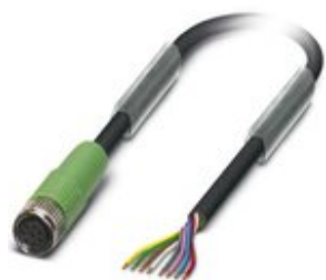
Sensor-/Aktor-Kabel, 8-polig, PUR halogenfrei, schwarzgrau RAL 7021, freies Leitungsende, auf Buchse gerade M8, Kabellänge: 3 m
