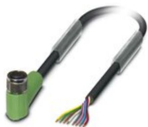
Sensor-/Aktor-Kabel, 8-polig, PUR halogenfrei, schwarzgrau RAL 7021, freies Leitungsende, auf Buchse gewinkelt M8, Kabellänge: 1,5 m
