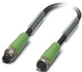
Sensor-/Aktor-Kabel, 8-polig, PUR halogenfrei, schwarzgrau RAL 7021, Stecker gerade M8, auf Buchse gerade M8, Kabellänge: 0,3 m
