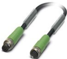
Sensor-/Aktor-Kabel, 8-polig, PUR halogenfrei, schwarzgrau RAL 7021, Stecker gerade M8, auf Buchse gerade M8, Kabellänge: 1,5 m
