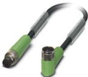
Sensor-/Aktor-Kabel, 8-polig, PUR halogenfrei, schwarzgrau RAL 7021, Stecker gerade M8, auf Buchse gewinkelt M8, Kabellänge: 0,6 m
