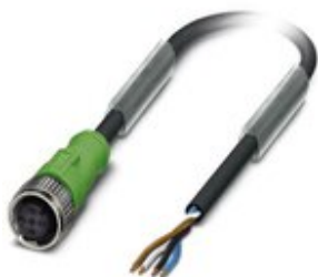
Sensor-/Aktor-Kabel, 4-polig, PVC, schwarz RAL 9005, freies Leitungsende, auf Buchse gerade M12, Kodierung: A, Kabellänge: 3 m
