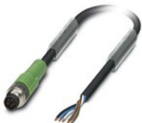
Sensor-/Aktor-Kabel, 5-polig, PUR halogenfrei, schwarzgrau RAL 7021, Stecker gerade M8, Kodierung: B, auf freies Leitungsende, Kabellänge: 1,5 m
