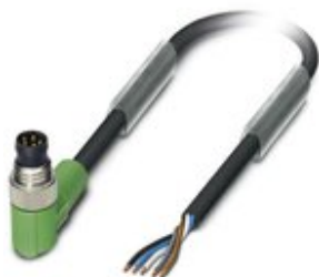
Sensor-/Aktor-Kabel, 5-polig, PUR halogenfrei, schwarzgrau RAL 7021, Stecker gewinkelt M8, Kodierung: B, auf freies Leitungsende, Kabellänge: 1,5 m
