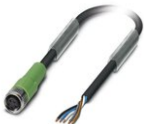
Sensor-/Aktor-Kabel, 5-polig, PUR halogenfrei, schwarzgrau RAL 7021, freies Leitungsende, auf Buchse gerade M8, Kodierung: B, Kabellänge: 10 m
