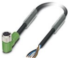
Sensor-/Aktor-Kabel, 5-polig, PUR halogenfrei, schwarzgrau RAL 7021, freies Leitungsende, auf Buchse gewinkelt M8, Kodierung: B, Kabellänge: 1,5 m
