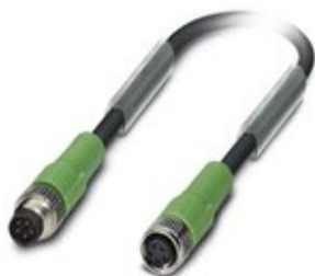
Sensor-/Aktor-Kabel, 5-polig, PUR halogenfrei, schwarzgrau RAL 7021, Stecker gerade M8, Kodierung: B, auf Buchse gerade M8, Kodierung: B, Kabellänge: 3 m
