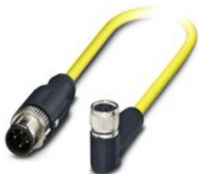
Sensor-/Aktor-Kabel, 4-polig, PVC, gelb, geschirmt, Stecker gerade M12, Kodierung: A, auf Buchse gewinkelt M8, Kabellänge: 1,5 m
