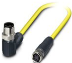
Sensor-/Aktor-Kabel, 4-polig, PVC, gelb, geschirmt, Stecker gewinkelt M12, Kodierung: A, auf Buchse gerade M8, Kabellänge: 0,5 m
