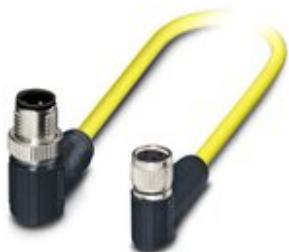
Sensor-/Aktor-Kabel, 4-polig, PVC, gelb, geschirmt, Stecker gewinkelt M12, Kodierung: A, auf Buchse gewinkelt M8, Kabellänge: 0,5 m
