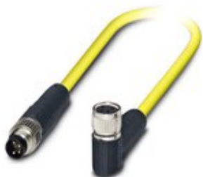
Sensor-/Aktor-Kabel, 4-polig, PVC, gelb, geschirmt, Stecker gerade M8, auf Buchse gewinkelt M8, Kabellänge: 0,5 m
