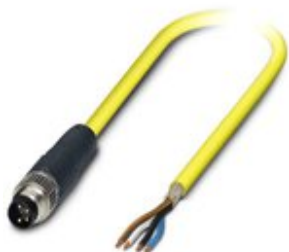
Sensor-/Aktor-Kabel, 4-polig, PVC, gelb, geschirmt, Stecker gerade M8, auf freies Leitungsende, Kabellänge: 10 m
