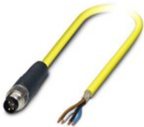
Sensor-/Aktor-Kabel, 4-polig, PVC, gelb, geschirmt, Stecker gerade M8, auf freies Leitungsende, Kabellänge: 2 m
