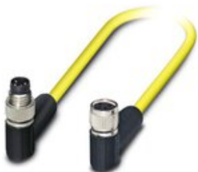
Sensor-/Aktor-Kabel, 4-polig, PVC, gelb, geschirmt, Stecker gewinkelt M8, auf Buchse gewinkelt M8, Kabellänge: 1,5 m
