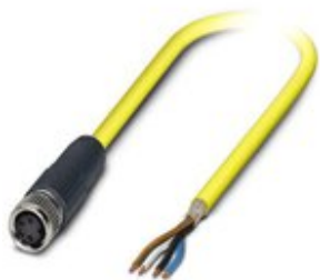
Sensor-/Aktor-Kabel, 4-polig, PVC, gelb, geschirmt, freies Leitungsende, auf Buchse gerade M8, Kabellänge: 2 m
