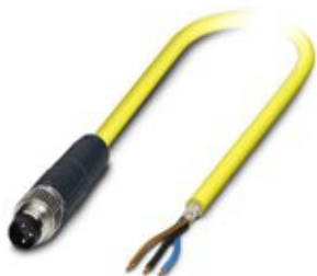
Sensor-/Aktor-Kabel, 3-polig, PVC, gelb, geschirmt, Stecker gerade M8, auf freies Leitungsende, Kabellänge: 2 m
