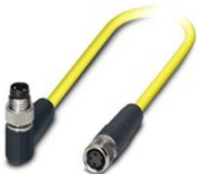
Sensor-/Aktor-Kabel, 3-polig, PVC, gelb, geschirmt, Stecker gewinkelt M8, auf Buchse gerade M8, Kabellänge: 0,5 m
