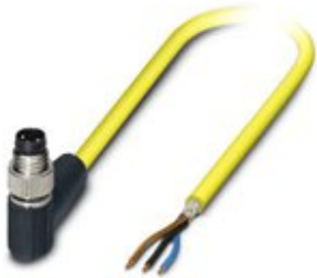
Sensor-/Aktor-Kabel, 3-polig, PVC, gelb, geschirmt, Stecker gewinkelt M8, auf freies Leitungsende, Kabellänge: 10 m
