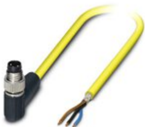
Sensor-/Aktor-Kabel, 3-polig, PVC, gelb, geschirmt, Stecker gewinkelt M8, auf freies Leitungsende, Kabellänge: 5 m
