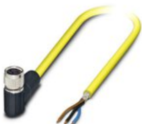
Kabel czujnika/urządzenia wykonawczego, 3-bieg., PCW, żółty, ekranowany, wolny koniec przewodu, na Gniazdo kątowe M8, długość kabla: 2 m
