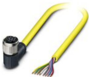
Sensor-/Aktor-Kabel, 8-polig, PVC, gelb, freies Leitungsende, auf Buchse gewinkelt M12, Kodierung: A, Kabellänge: 10 m
