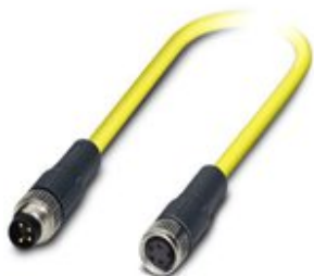
Sensor-/Aktor-Kabel, 4-polig, PVC, gelb, Stecker gerade M8, auf Buchse gerade M8, Kabellänge: 1,5 m
