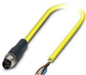
Kabel czujnika/urządzenia wykonawczego, 4-bieg., PCW, żółty, Wtyki proste M8, na wolny koniec przewodu, długość kabla: 10 m
