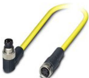
Kabel czujnika/urządzenia wykonawczego, 4-bieg., PCW, żółty, Wtyki kątowe M8, na Gniazdo proste M8, długość kabla: 1,5 m
