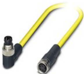
Sensor-/Aktor-Kabel, 4-polig, PVC, gelb, Stecker gewinkelt M8, auf Buchse gerade M8, Kabellänge: 0,5 m
