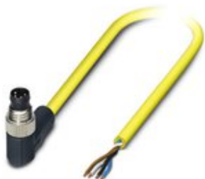
Sensor-/Aktor-Kabel, 4-polig, PVC, gelb, Stecker gewinkelt M8, auf freies Leitungsende, Kabellänge: 10 m
